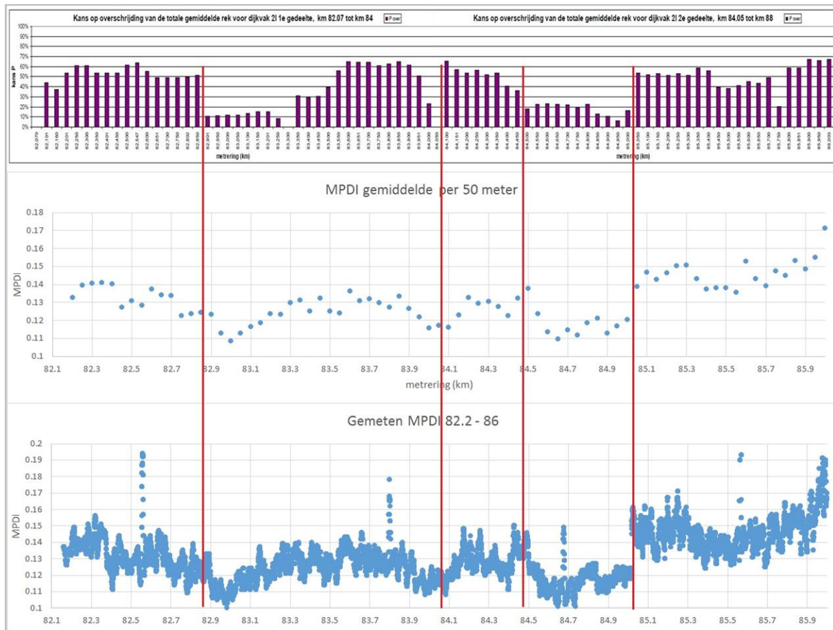
Figuur 16 – Vergelijking methoden voor sterktebepaling d.m.v. VGD en MIRA
