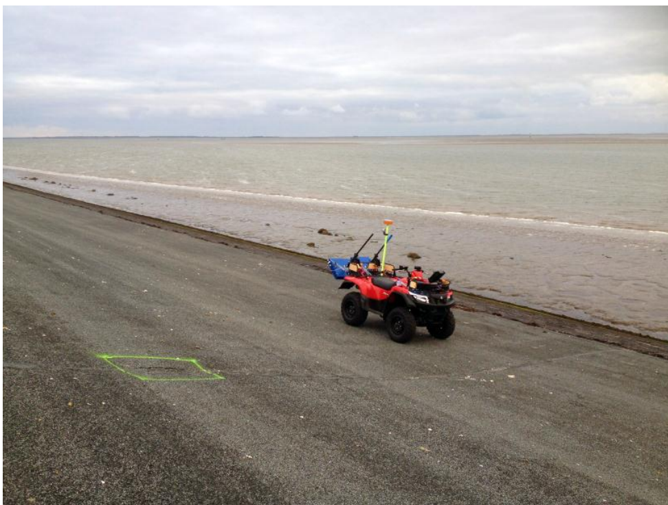
Figuur 3 – Miramax meetsysteem op locatie Lauwersmeerdijk
